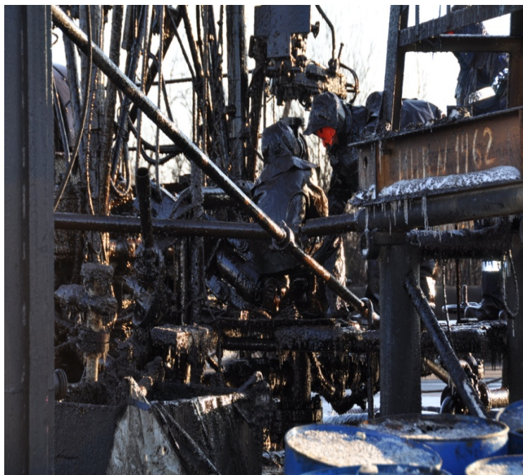
Рис. 2. Последствия выброса газонефтяной смеси из скважины
